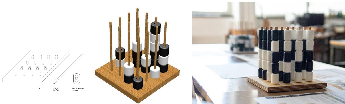
Slika 13: Načrt, 3D vizualizacija igre 3D 4 v vrsto in prototip iz vezane plošče in plastičnih žetonov, Rok Kladnik (IOI), foto: Jure Zagoranski (IOI)
