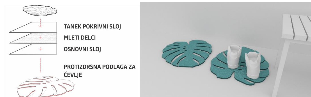
Slika 27: Skica in koncept izdelave ter 3D vizualizacija protizdrsne podlage za čevlje, Nejc Dornik (IOI)
