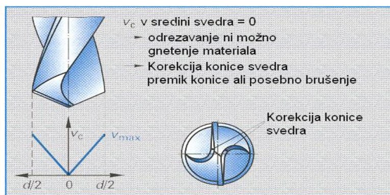
Slika 5.37: Rezalna hitrost je odvisna od premera svedra
