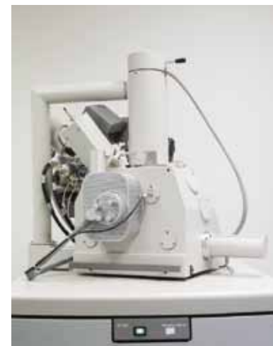
Vrstični elektronski in ionski mikroskop FEI Quanta 200 3D
