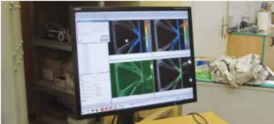
3D meritev in analiza deformacij
