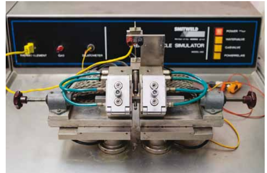
Simuliranje in analiziranje delov toplotno vplivnega področja - TVP
